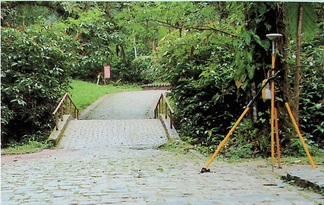
Figura 5 – Posicionamento do DGPS e antena, sobre as bases ST-01 (à frente) e ST-00 (ao fundo), utilizadas para a coleta de dados de coordenada, posicionadas de forma a possibilitar uma perfeita visualização de uma base para a outra.
