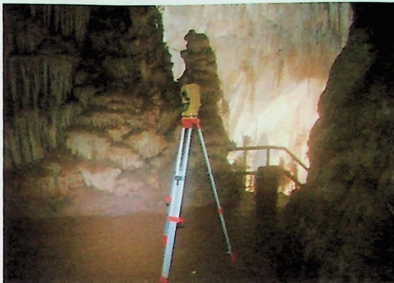
Figura 3 – Estação total posicionada sobre base fixa localizada em passarela de concreto, com marcação em tinta amarela na região central da abertura do tripé (ST15).
